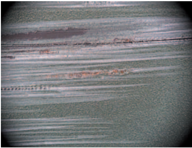
BILD 3: 2,6-cm-Kratzspur (70-fache Vergrößerung) FIGURE 3: 2.6 cm scratch mark (70x magnification)
