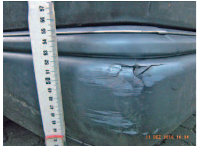
BILD 6: Anstoßstelle mit Beschädigungen FIGURE 6: Impact point with damage
