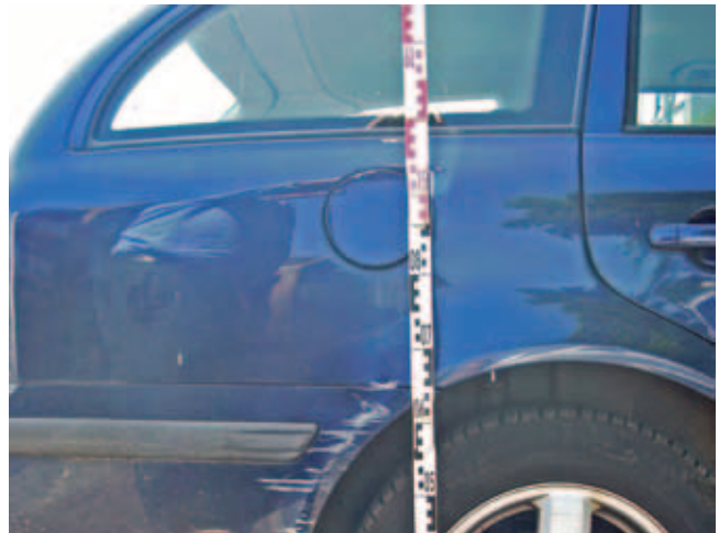
BILD 10: Schadenbild am Skoda hinten rechts FIGURE 10: Damage pattern on the rear right of the Skoda
